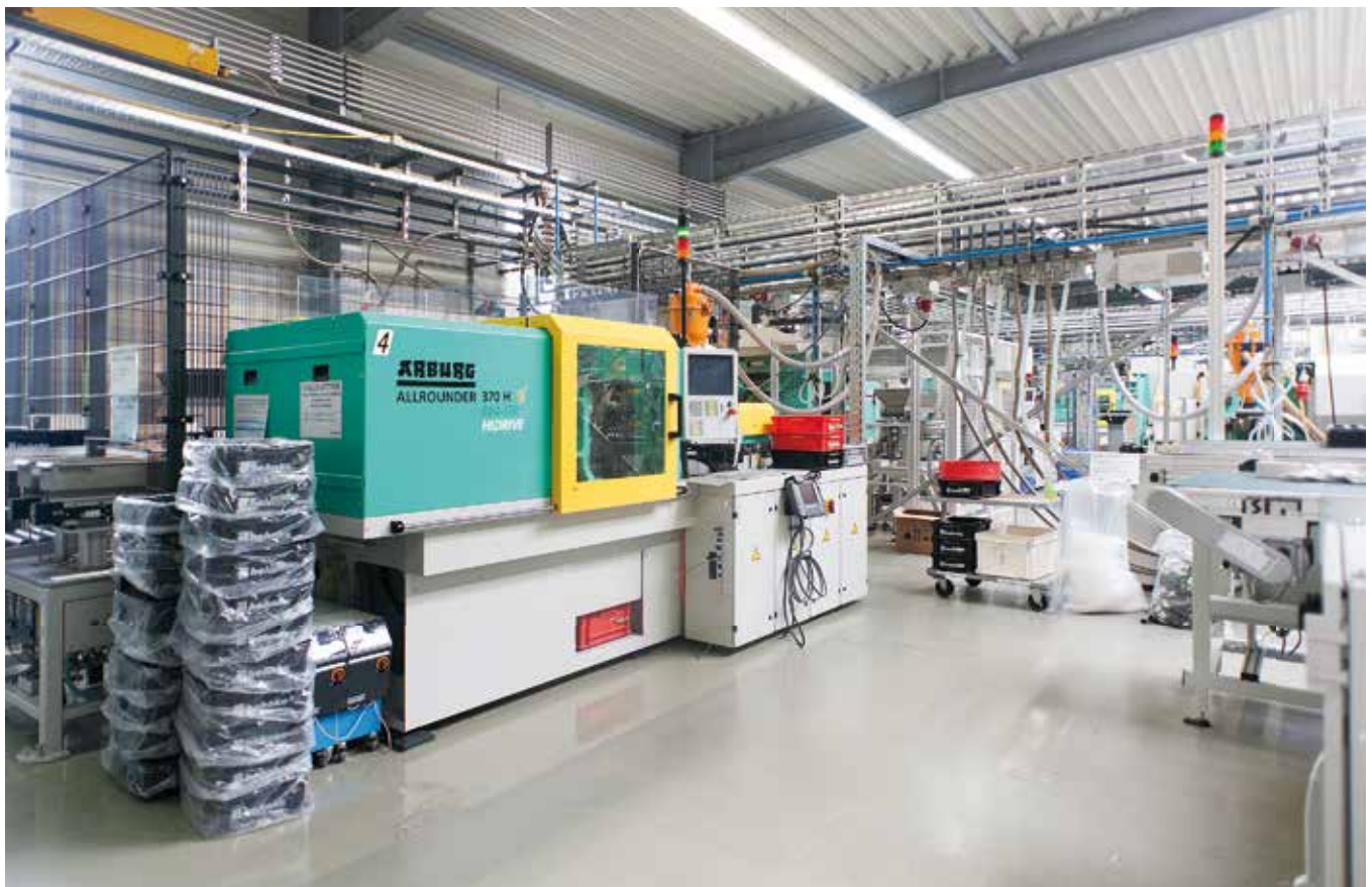
Alle 25 Maschinen der Spritzgießfertigung werden von den Hallenwänden her automatisch mit getrocknetem Material beschickt.
