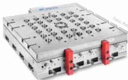
Das Multi Nozzle System von Peta erlaubt enge Düsenabstände, was die mögliche Anzahl von Düsen erhöht. Hier sind 64 gekühlte Düsen auf einer Fläche von 396 x 426 mm untergebracht.
