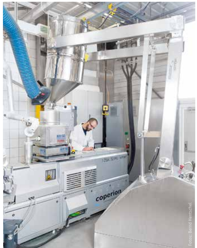
Der Fasskipper übernimmt die Zudosierung des vorgemischten Materials in den Extruder – die niedrige Bauhöhe des ZSK 32 MC 18 smart sorgt für eine unkomplizierte Bedienung.
